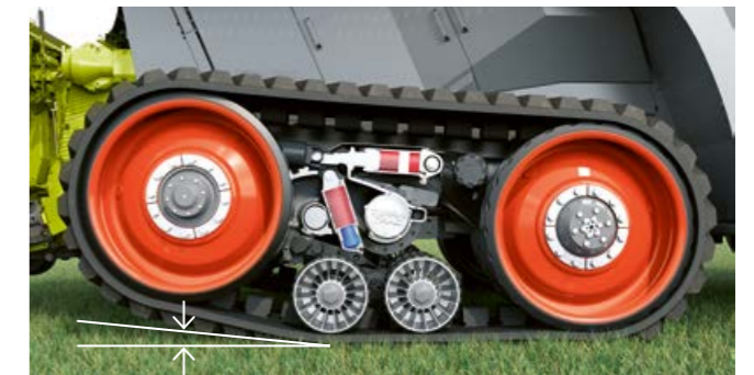
66% de superficie de apoyo: El rodillo de rodaje es levantado en hasta 100 mm.
