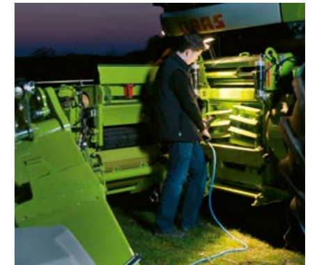
QUICK ACCESS permite la inspección de los órganos picadores en pocos minutos.
