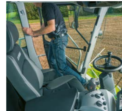
El interruptor del asiento desconecta automáticamente el cabezal y la transmisión principal.
