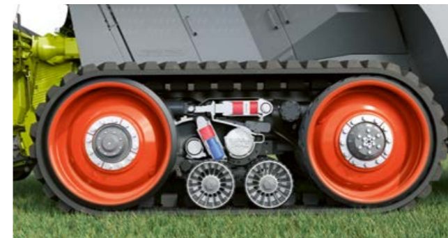
100% de superficie de apoyo: El rodillo de rodaje tiene pleno contacto con el suelo.
